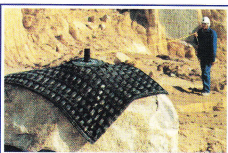
7. Attivare il detonatore tirando il filo a 7 m. di distanza
