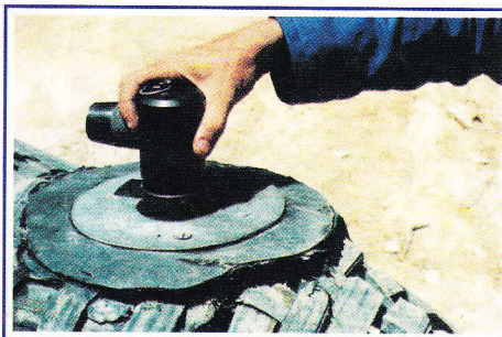
5. Avvitare il detonatore nella culatta
